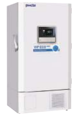
【スペック】 DU703-VHS1 ①ノンフロン自然冷凍で省エネ(フロン排出抑制法 対象外) ②新型10.1インチ 大型パネル採用 ③向上したセキュリティ対策を装備
