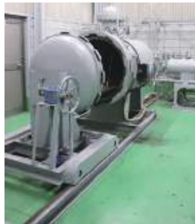
絶縁型防爆バリアの安全試験を行う装置を社内設置
