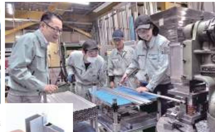
531号での取材の際に撮影したアルミフレームのカット加工作業風景はとても楽しそうだった。作品が出来上がるのを技術者のみなさん全員がわくわく見守っている様だった。四角の中はフレームの連結部。「OUT-IN連結方式」と言って一人でも組み立てられる。特許取得済
